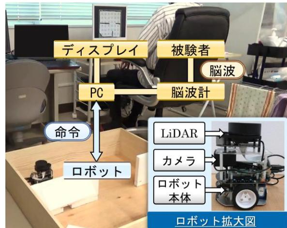
図 1 自律走行ロボットと BMI システムの構成
